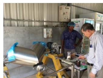
写真2. カンボジア食品工場において 栄養強化プレミックスと普通米を混合 (1:200)
